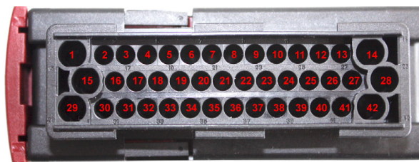
Pin-Belegung des Anschlussstecker S1
