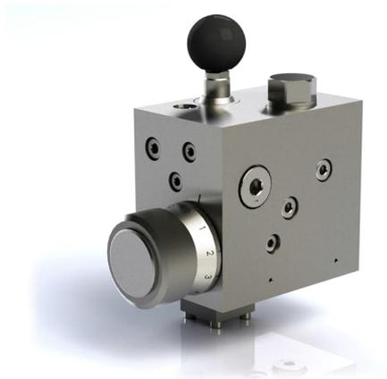
Das handbetätigte Stromregelventil teilt die Eingangsmenge in eine kleinere Ausgangsmenge und dient zur lastdruckunabhängigen Versorgung eines hydraulischen Verbrauchers. Mit dem Ventil kann z.B. die gewünschte Geschwindigkeit für einen Kratzbodenantrieb eingestellt werden.
